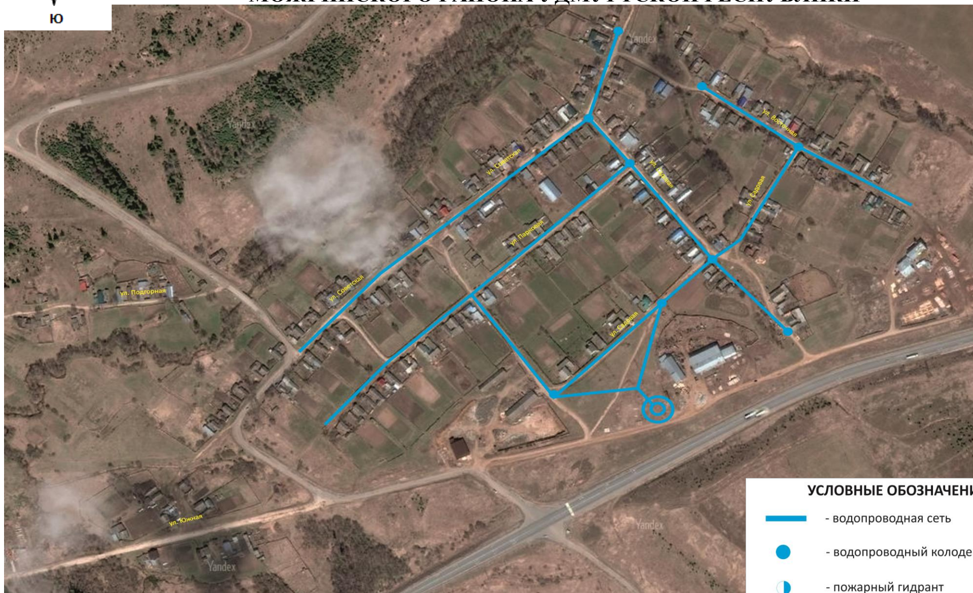
Карта (схема) существующего размещения объектов централизованной системы водоснабжения д. Лудзи-Шудзи
